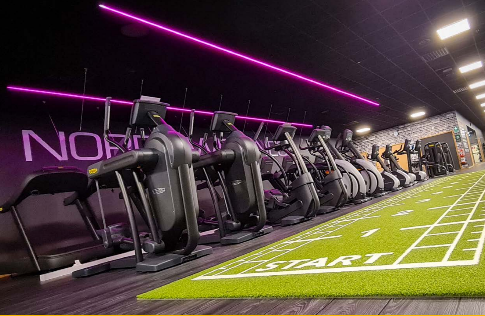
LED-strip RGB 15W/m Profil utanpåliggande PN6 27x26mm
